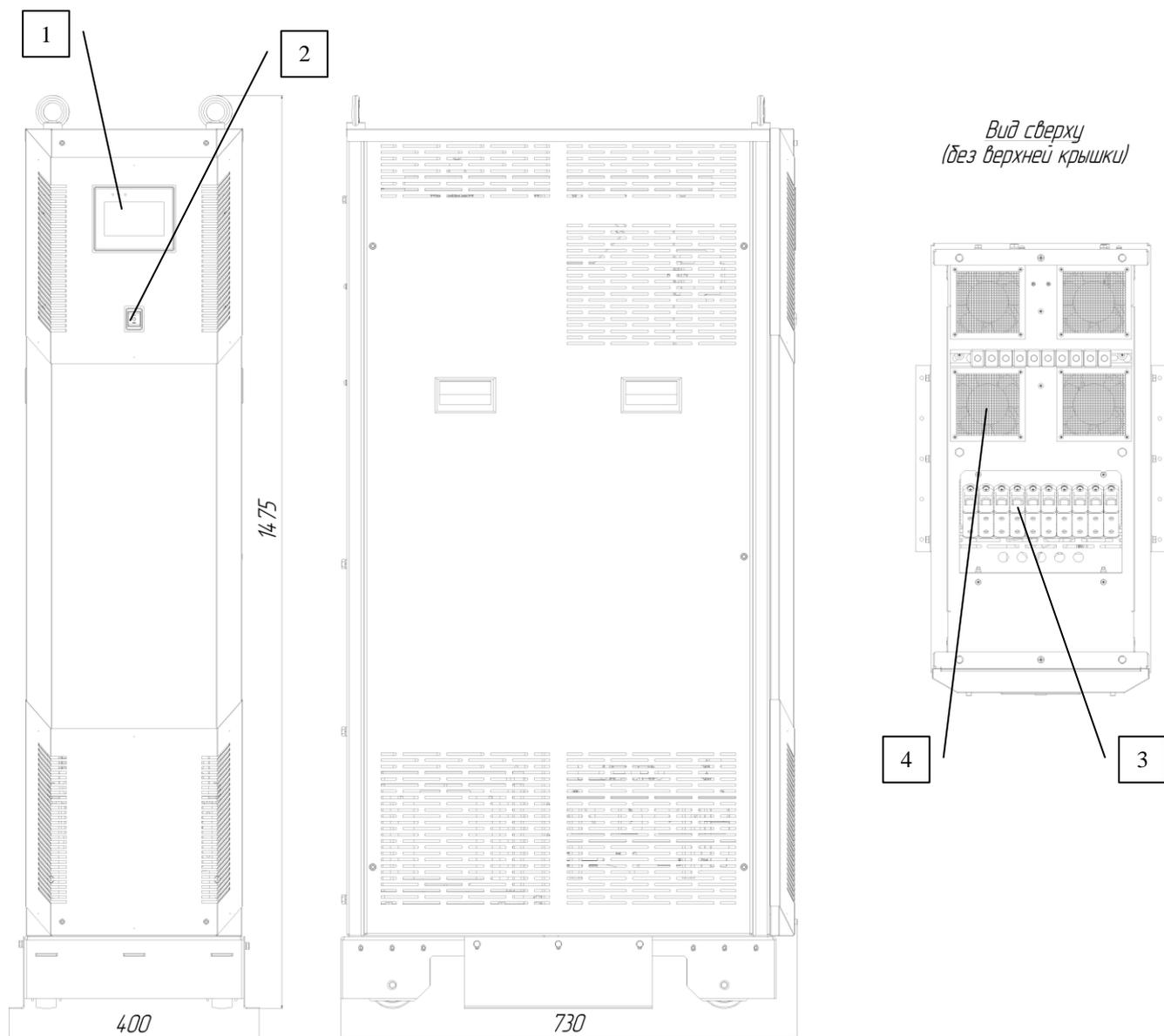
Рис.1. Внешний вид стабилизатора: 1 – панельный компьютер; 2 – переключатель режимов работы стабилизатора; 3 – клеммники для подключения силовых кабелей; 4 - вентиляторы.
